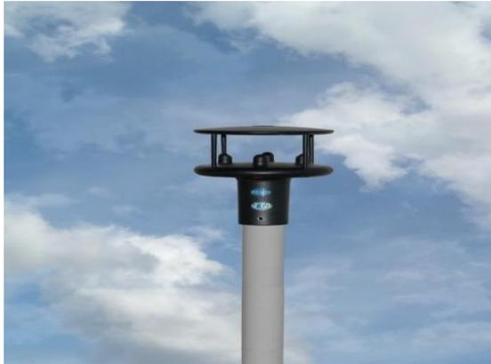
Figura 11: Exemplo de um anemómetro ultrassónico
