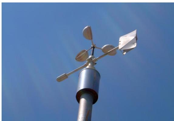
Figura 10: Exemplo de um anemómetro de copos
