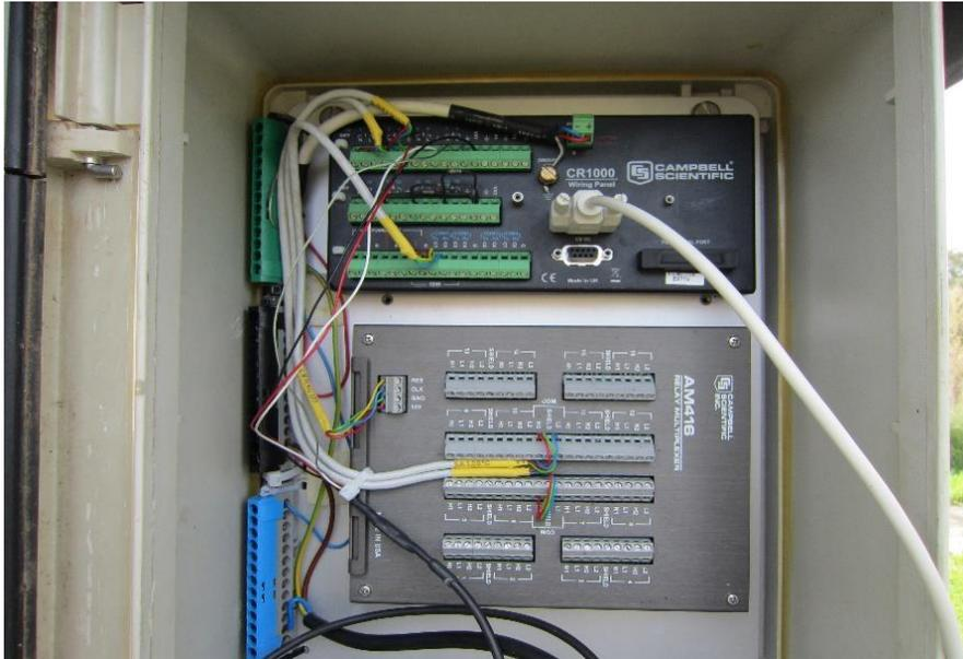
Figura 17: Caixa de registo dos valores, com o CR1000 instalado e o multiplexer por baixo
